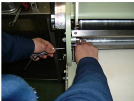
手前側のカキ板のスプリングが上にあることを確認してから、手前側のカキ板取り付けピンを六角レンチで締めてカキ板を固定して下さい。ピンがカキ板の穴に入っているかを少しゆすって確認して下さい。
