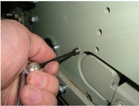
4. ナットの中側にある黒いネジを六角レンチで緩めます。黒いネジをカキ板が外れるまで緩めて下さい。ネジを緩めてゆくと、カキ板が落下するので、次の写真を参考にカキ板を押さえながら作業を進めて下さい。(左の写真はナットをはずして撮影しています)
