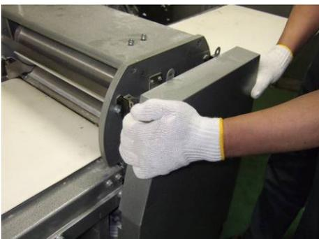
カキ板が抜けない場合は、無理に引っ張らずに裏側のチェーンカバーをはずし、2の要領で奥側のアルミガイドをはずして下さい。その際に奥側のカキ板のピンを止めているネジは触らないで下さい。
