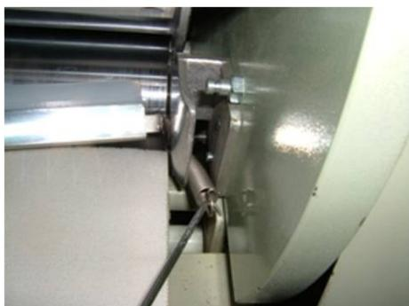
写真の位置までスプリングを上げたらカキ板の取り付けピンにカキ板を差し込みます。
