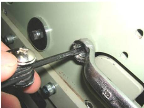
カキ板の取り付け位置が決まったら、ナットを締めて固定します。その際にカキ板を固定するピンの位置を動かさないように写真の様に六角でピンを固定しながらナットを締めて下さい。締めすぎますとピンが破損しますのでご注意ください。アルミガイドを取り付け、スプリングを掛ければ完了です。
