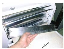
5. カキ板を抜いて新しいものと交換します。(カキ板が取れない場合は反対側のピンもはずしてください)
