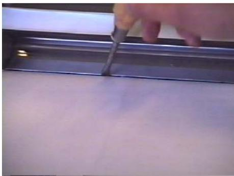
6. ベルトとカキ板のすき間を調整（すき間を2mm程度開けて、カキ板が反転できる様に調整して下さい）しながらテーブルのボルトを固定して下さい。
