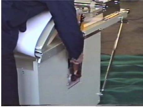
3. テーブルをたたんで持ち、チェーン側にテーブルを傾け、チェーンを外してテーブルを降ろします。
