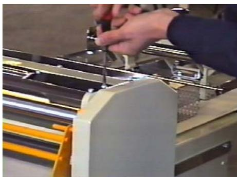
1.機械が停止していること、コンセントを抜いてあることを確認の後、裏カバーをとめているネジを2本緩めます
