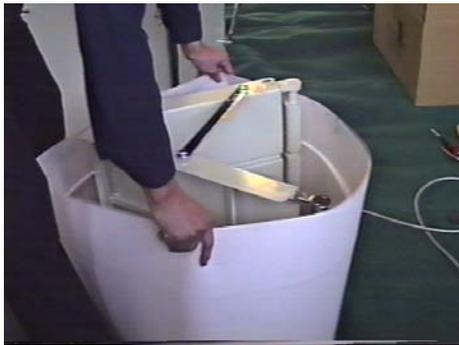
4. 外したテーブルを、古新聞などを敷いた床に置いて下さい。その状態でベルトを新しいものと交換して下さい。
