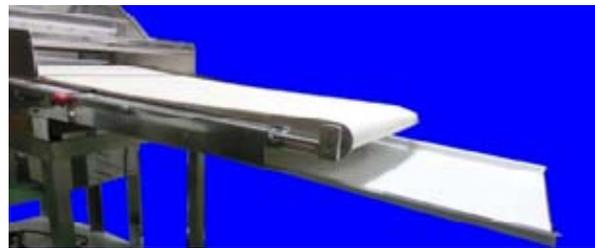
両側の受けロールのナットをベルトが緩む方へ回します。(左写真)
