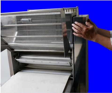
3.後ろ側のチェーンカバーをはずします。カバーの下側に引掛けがありますので、カバー上方を手前側にごく軽く倒したのち、上方に持ち上げて下側の引掛けをはずしてから、手前に引いてはずして下さい。破損の原因になりますのでカバーを手前に倒す際は無理に力をかけないで下さい。カバーを落下させると破損及び足などを怪我する危険がございますので取扱いには十分お気をつけ下さい。
