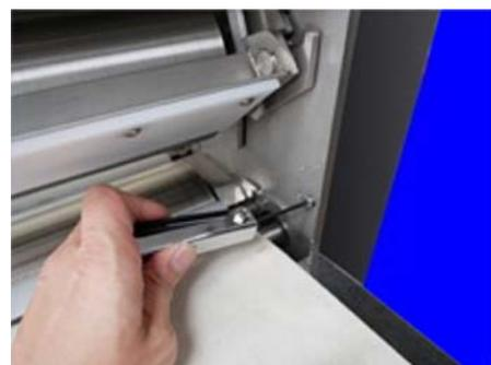
2.後ろ側のチェーンカバーを止めているボルト4本を外します。
