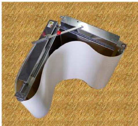
8.ベットを降ろしたら、写真の様な状態で古いベルトを抜いて新しいベルトと交換して下さい。
