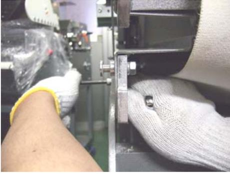
6.ベット（テーブル）を固定している前側・後ろ側計4本のボルトを外します
