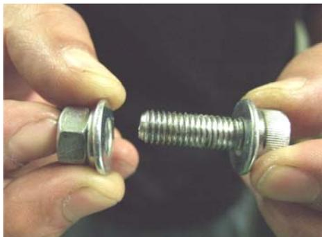
1. ベット固定の際は写真のように表側がキャップボルトと平ワッシャー、裏側が平ワッシャー・スプリングワッシャー・ナットの順に取り付けて下さい。
