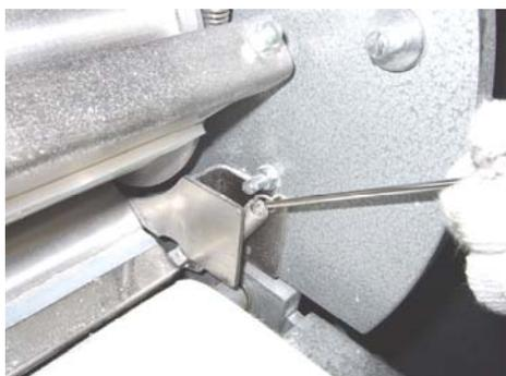
2. ベットを仮固定したら、まずチェーンを取り付けます。チェーンが短くて掛からない場合はベットをロール側に押し込んで、更にベットを折りたたむとチェーンが掛けやすくなります。チェーンの取り付け後、ベルトの張り調整をしてください。ベルト調整後、下側のカス取り板のスプリングをフックから外し、カス取り板を反転できるようにして下さい。
