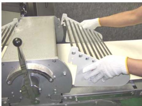
1.機械が停止していること、コンセントを抜いてあることを確認の後、安全カバーを外します。
