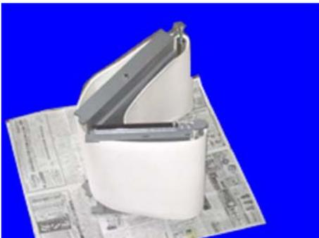
8.ベットを降ろしたら、写真の様な状態で古いベルトを抜いて新しいベルトと交換して下さい。
