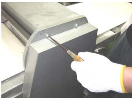
2.後ろ側のチェーンカバーを止めているネジ2本を外します。ネジを全て外しますとカバーが倒れる恐れがありますのでカバーを押さえながら作業して下さい。
