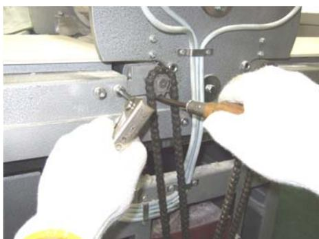
4. ベットを固定したら、チェーンの張りを調整します。
