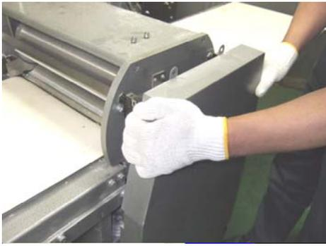
3.チェーンカバーを外します。カバーを落下させると破損する危険、及び足などを怪我する恐れがございますので取扱いには十分お気をつけ下さい。
